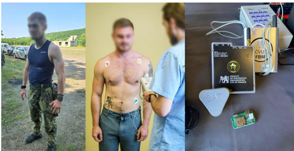
Obrázek 1: Ukázka komerčních systémů – hodinky Garmin, ultra human ring, tričko Hexoskin, systém Cosinus (vlevo); ukázka zařazení pro snímání EKG (uprostřed); ukázka vývoje multisenzorického zařízení pro monitoring fyziologických a pohybových dat na FBMI v Kladně (vpravo).
