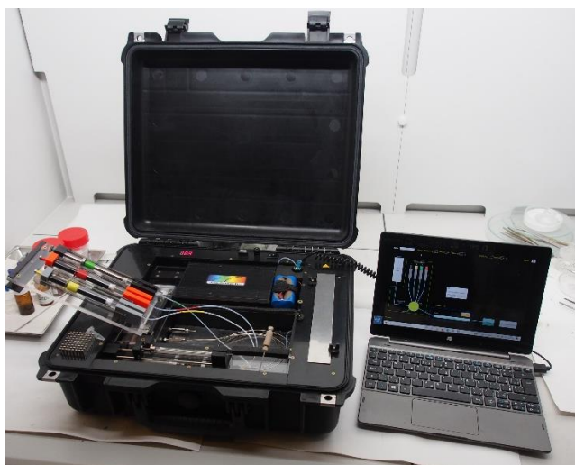
Obrázek 1: Přenosný kapilární kapalinový chromatograf miniLC 1
