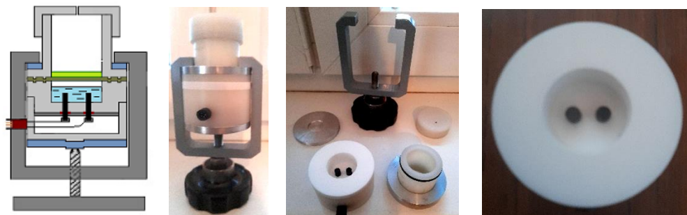
Obrázek 6: Reálný vzhled modifikované permeační cely pro sledování průběhu permeace těkavých toxických kapalin s acidobazickými vlastnostmi
