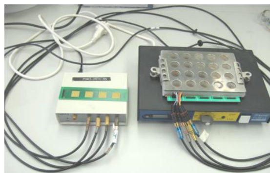
Obrázek 13: Kombinace zařízení KONDUKTOTEST s destičkami inovovaného MINITESTU pro automatické sledování penetrace kapalin s acidobazickými vlastnostmi
