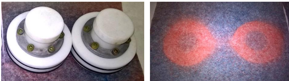
Obrázek 11: Barevná změna detekční textilie impregnované acidobazickým indikátorem vyvolaní již krátkým působením par HCl
