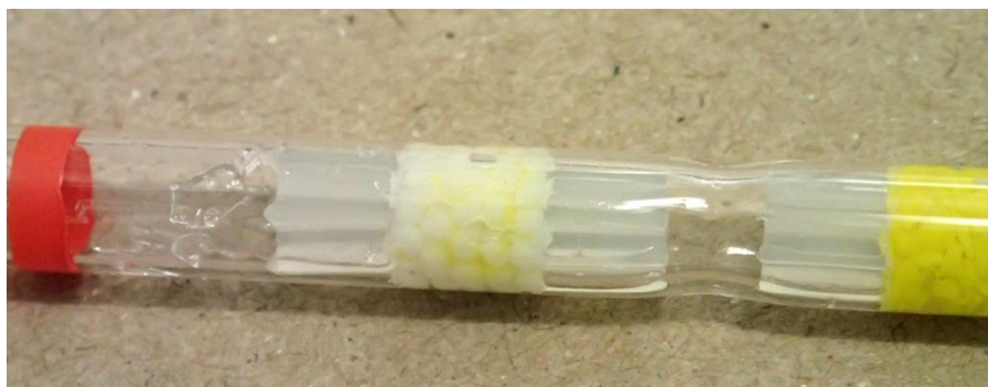
Obrázok 3: Zafarbenie indikačnej vrstvy DT 11 pri presávaní vzduchu kontaminovaného Sarinom
