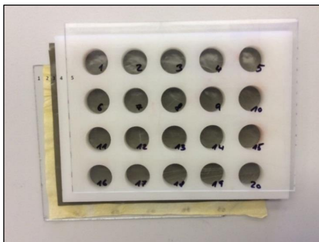
Obrázek 3: Upravená sestava MINITEST využívající PVDF desku (pohled shora)
