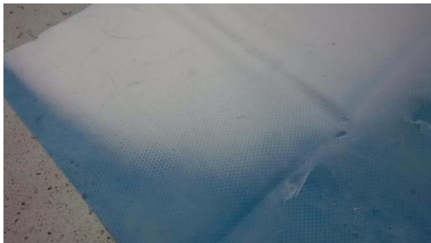
Obr. 3: Vzorek nosného PP s nanesenou vrstvou PVB s obsahem oxidu těžšího prvku
