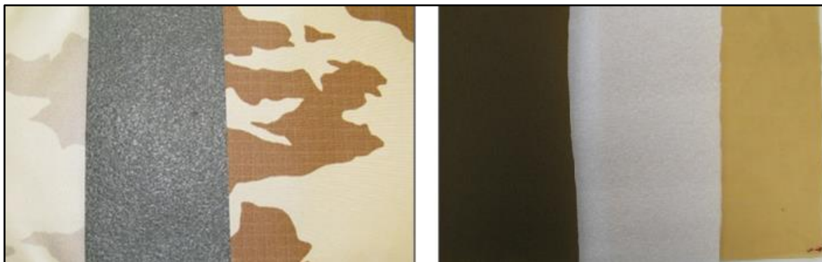
Obrázek 9: Tkaniny batohu AČR – vlevo (šedě zbarvená vrstva – vnitřní izolační vrstva z pěnového materiálu) a batohu Source Tactical 3L – vpravo (bíle zbarvená vrstva – vnitřní vrstva z pěnového materiálu)
