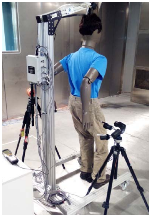
Obrázek 4 Pohled na měřicí zařízení zezadu. Na stativích v blízkosti dlaní jsou umístěna čidla teploty a vlhkosti okolního vzduchu
