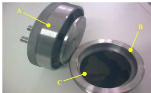
Obrázek 3 Testovací modul s vloženým materiálem po dekontaminaci (A. horní víko; B. základna modulu; C. testovaný materiál po dekontaminaci)
